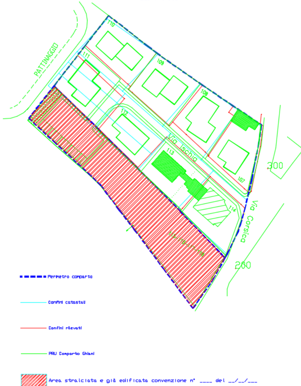
Planimetria di sovrapposizione Rilievo Topografico - Cartografia Catastale - P. R. U. approvato scala 1:500
