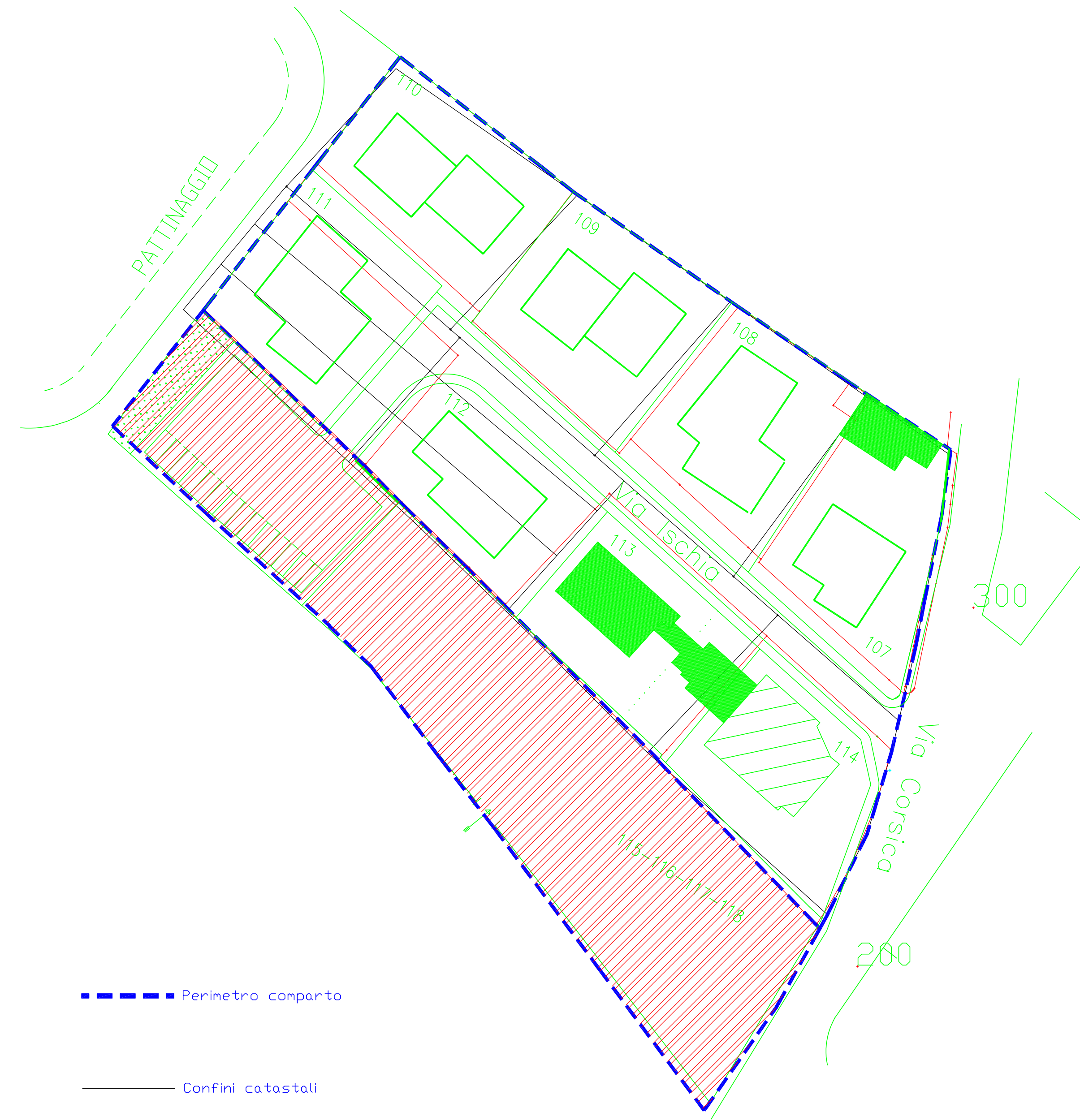
Planimetria di sovrapposizione Rilievo Topografico - Cartografia Catastale - P. R. U. approvato scala 1:500
